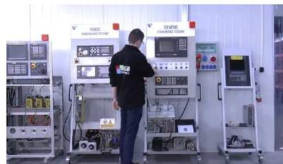
Wir verfügen über von uns entwickelte Prüfstände, mit denen wir prüfen, ob das Gerät funktionsfähig ist. Sie sorgen dafür, dass MITSUBISHI ELECTRIC MDS-A-V1-05 repariert wird.
